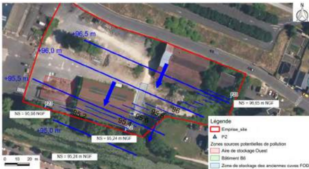
Figure 28 : Localisation des piézomètres et sens d'écoulement de la nappe.
